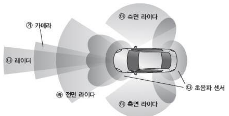
△ <그림1> (출처: 2022학년도 수능특강 독서) 자율 주행 자동차에 사용되는 센서
